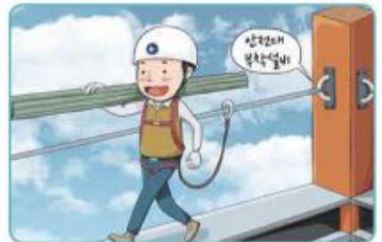
6 안전대 착용 시 안전대 부착설비 설치
