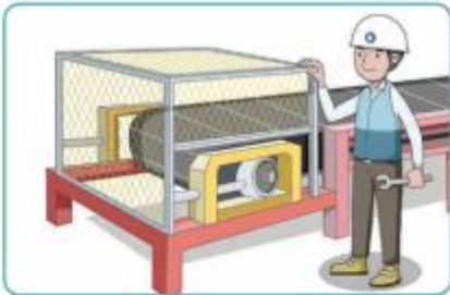
1 원동기, 회전축 등에 덮개, 울 등 설치
