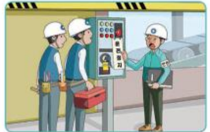
3 기동장치 잠금조치, 표지판 설치
